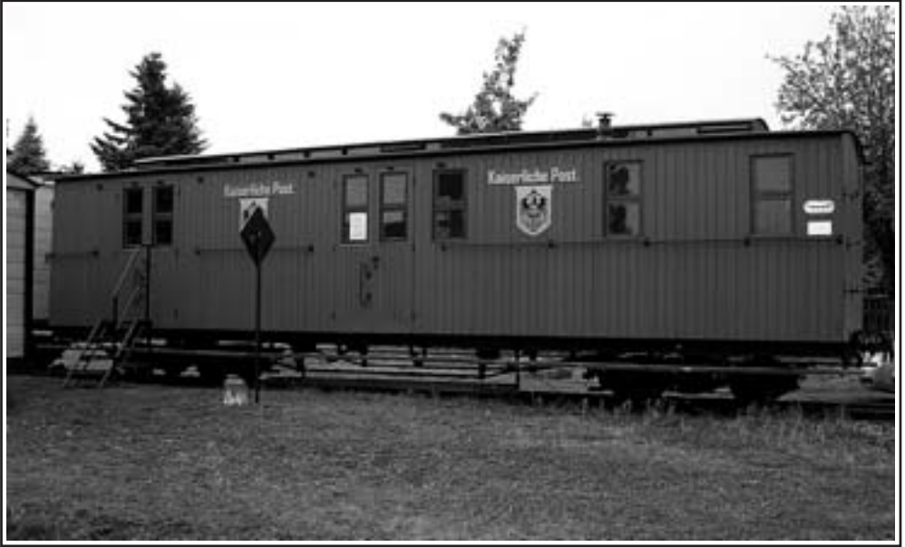
Die IG Verkehrsgeschichte Wilsdruff hat den äußeren Wiederaufbau des vierachsigen Postwagens 2680 aus dem Jahr 1908 abgeschlossen. Sein hölzerner Wagenkasten entstand durch Mitarbeiter des SUFW in Dresdner Hafen weitgehend neu. Am 2. und 3. Oktober 2004 konnte der Wagen beim Wilsdruffer Stationsfest der Öffentlichkeit präsentiert werden. Die Aufarbeitung wurde am 8. Dezember 2004 mit dem 1. Preis des vom VSSB gestifteten Claus-Köpcke-Preises gewürdigt. Foto: R. Fischer
