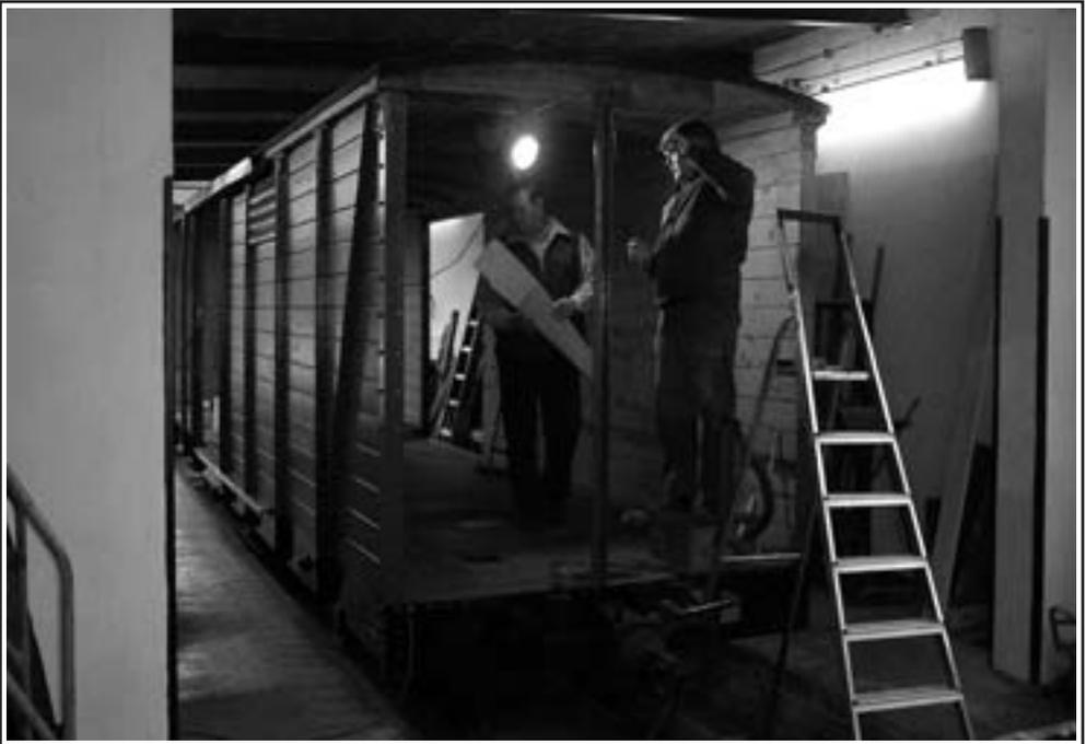
*97-14-19 auf dem Turnerweg; eine Stirnwand ist freigelegt, der Stirnwandspriegel ist angefault und muß teilweise erneuert werden. Foto: R. Fischer*
