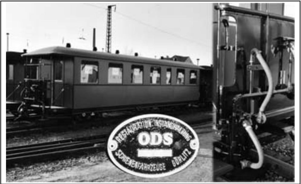
*Der zum Bestand des DB Museums gehörende Traditionswagen 970-405 ist nach seiner Aufarbeitung bei der ODS in Görlitz zurück in Radebeul Ost und hat nun zusätzlich zur bisherigen Saugluftbremse auch eine Druckluftleitung. Die Sparte »RIS« (Restauration Instandhaltung Schienenfahrzeuge) ist inzwischen bei der ODS Bautzen ausgegliedert worden und soll unter Regie der BMS und an einem anderen Werkplatz in Görlitz weiterlaufen. Foto: Rainer Fischer*
