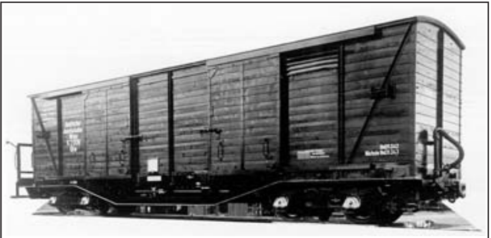
Die für die Schmalspurbahnen der Ostmark gebauten GG wiesen viele Baumerkmale der neueren sächsischen GGw auf, stammte deren Konstruktion doch auch von der Wumag. Foto: Sammlung R. Fischer
