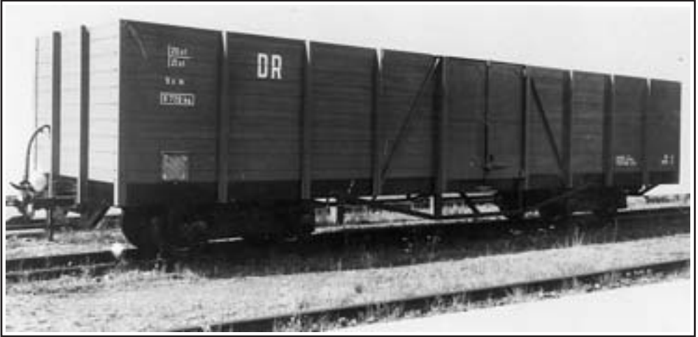
Wumag-Fabrikfoto und Maßskizze des Leichtbau-00m aus dem Jahre 1942. Dieses Fahrzeug wurde im Raw Karl-Marx-Stadt 1956 in einen gedeckten Wagen umgebaut und als Bahndienstwagen des Bw Wilsdruff verwendet.
