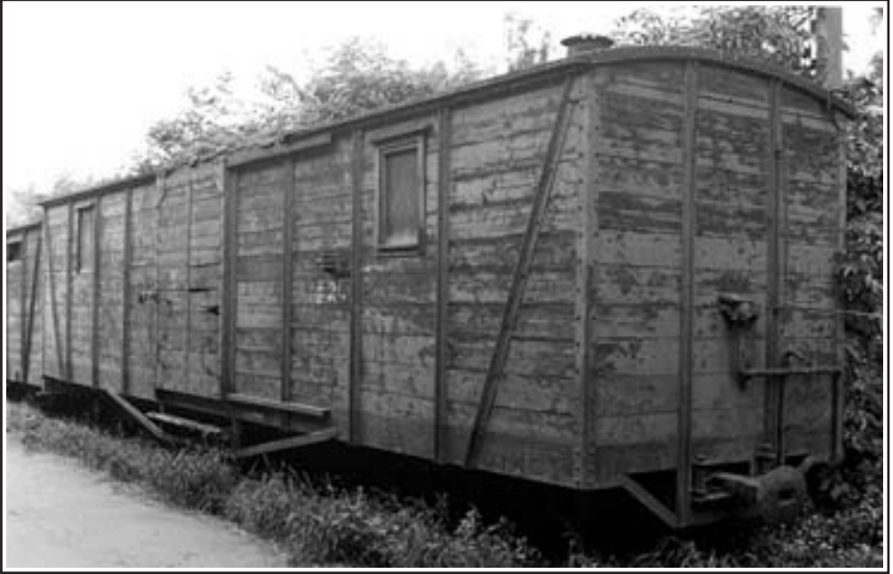
Auf den ersten Blick mit dem originalen Leichtbau-GGm zu verwechseln ist 97-09-80, der aber aus dem offenen Wagen entstand. Foto: R. Fischer
