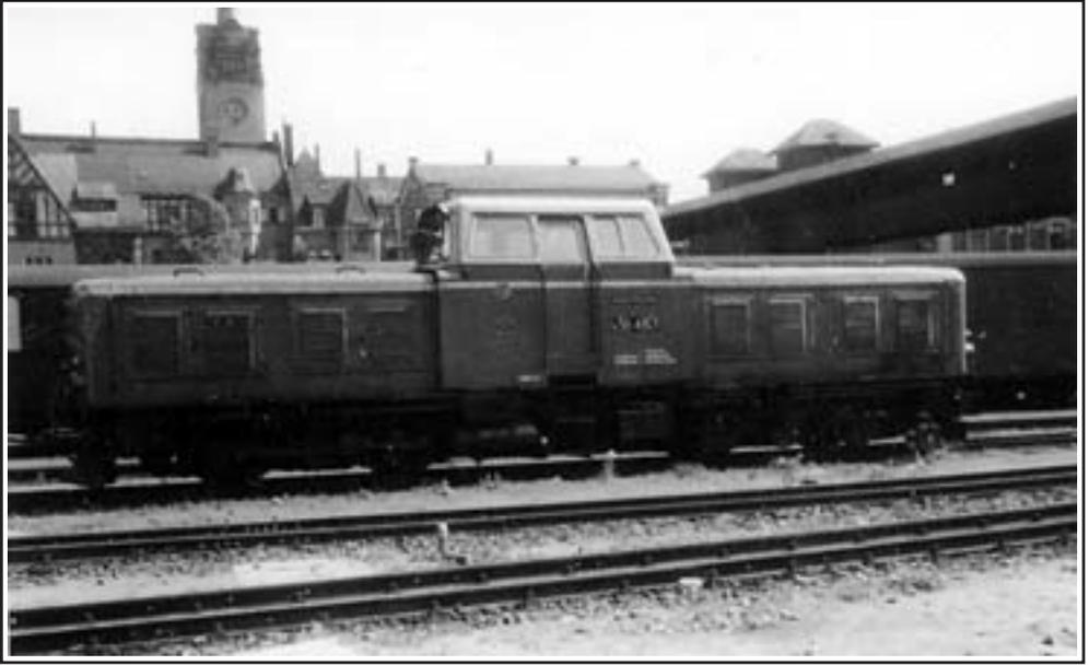
druff. V36 4802 stand teilweise konserviert noch immer im Bw Zittau. Bei ihr fehlte bereits der Hilfsdiesel, der von der HvM für die Heizkesselerprobung der V180 freigegeben worden war, sowie ein Antriebsmotor, den das Bw Zittau gerade als Ersatzteil für eine V15 ausbaute. Vor einer Wiederinbetriebnahme der Maschinen war also unbedingt eine HU erforderlich.
