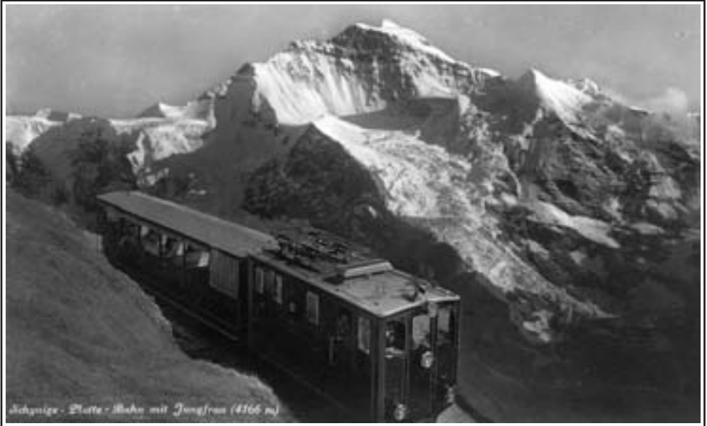
He 2/2 12 der Schynige-Platte-Bahn vor dem Jungfraumassiv, wahrscheinlich als gestellte Aufnahme zur Zeit der Elektrifizierung – die Oberleitung fehlt nämlich (noch). Foto: Sammlung A. Kroß
