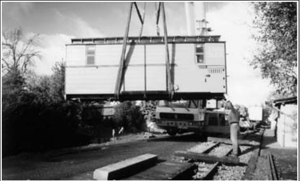
Langsam schwebt der aufgearbeitete Kasten des Gepäckwagens 1441K in Wilsdruff Hp auf seine provisorische Unterlage. Foto: Peter Wunderwald
